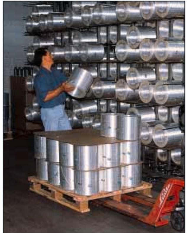
Figura 6: in passato le bobine di fibre di vetro del peso di 25 kg venivano posizionate manualmente per la lavorazione.
